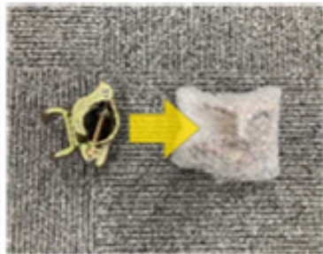
1. 単管用取付金具を緩衝材で保護
